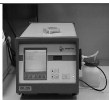
Figura 2. Densímetro ANTON PAAR DSA-5000
